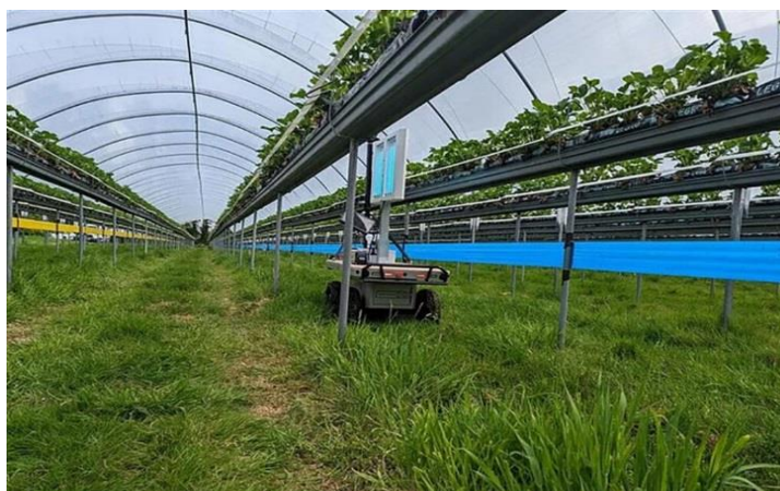
شکل ۲. مدیریت بیماریهای گیاهی با کمک نور فرابنفش UV
