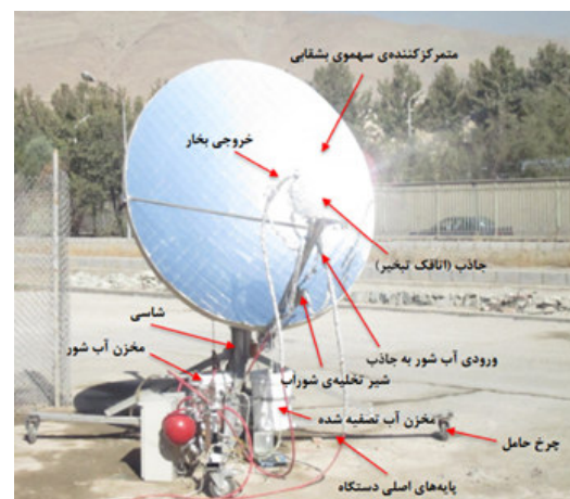
شکل ۱۰- دستگاه نمک‌زدایی خورشیدی با کانون نقطه‌ای [۲۴]
