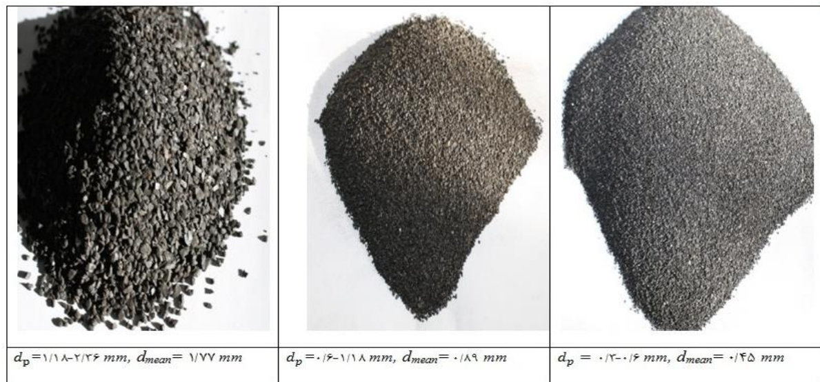
شکل ۲: ذرات زغال سنگ بعد از غربال و تقسیم بندی آن‌ها.
