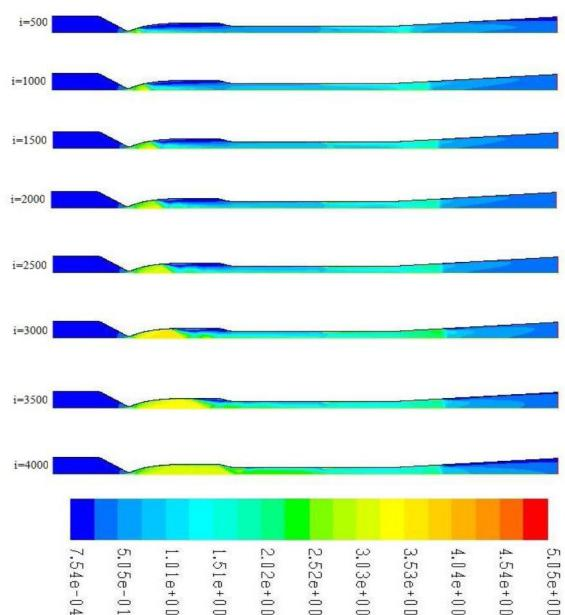
شکل ۹. کانتور عدد ماخ تونل باد با انژکتور
