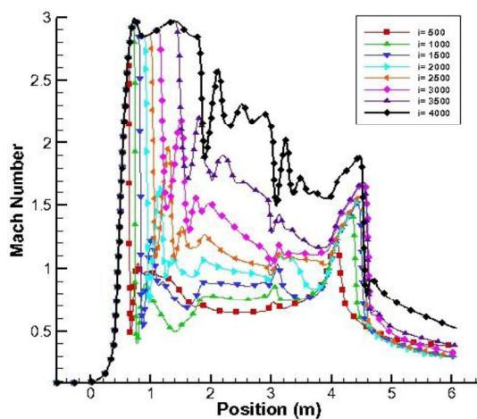
شکل ۱۲. نمودار عدد ماخ در راستای محور تونل باد همراه با ایزکتور و در تکرارهای مختلف
