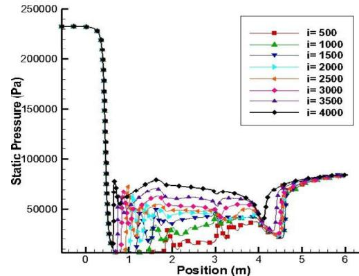
شکل ۱۵. نمودار تغییرات فشار استاتیک در راستای محور تونل با ده همراه با انژکتور و در تکرارهای مختلف
