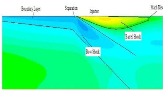
شکل ۲۶. بزرگنمایی کانتور عدد ماخ در ناحیه تزریق
