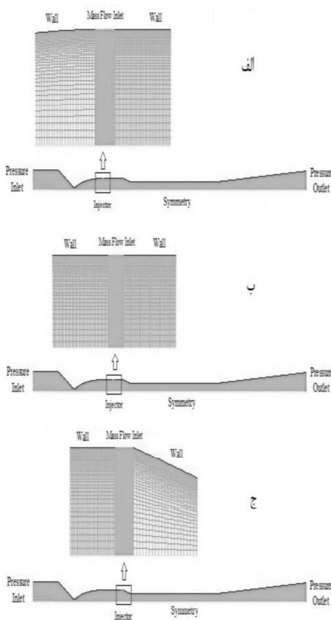
شکل ۳. مش بندی تونل همراه با انژکتور(الف) تزریق در ابتدای مقطع آزمون، (ب) تزریق در وسط مقطع آزمون و (ج) تزریق در انتهای مقطع آزمون
