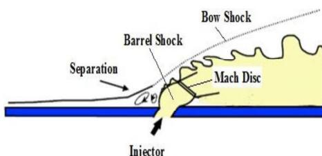
شکل ۲۴. شماتیک تلاقی یک جت با زاویه حاده با جریان مافق صوت [۲۰]
