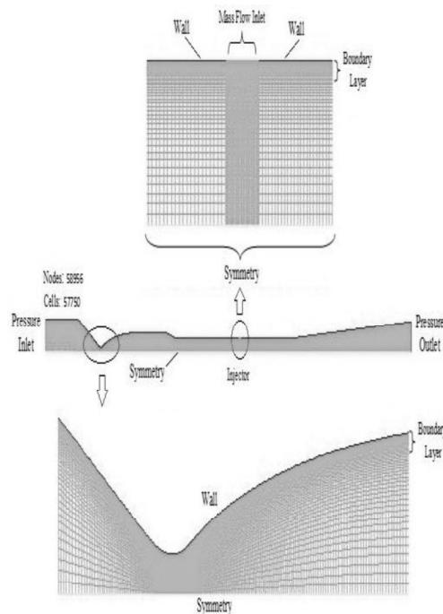
شکل ۶. مش بندی تونل باد با انژکتور
