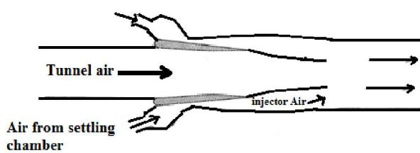
شکل ۲. دیفیوزر با سیستم تزریق کننده [۲]
