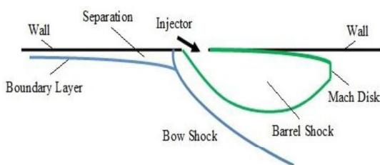
شکل ۲۷. تصویر شماتیک فیزیک تزریق جریان درون تونل
