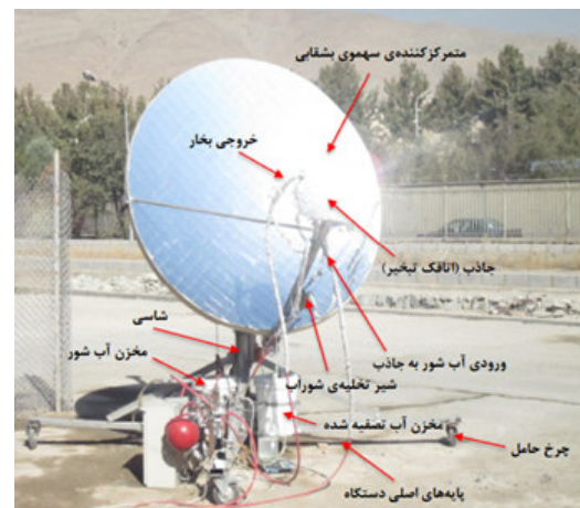
شکل ۱۰- دستگاه نمک‌زدایی خورشیدی با کانون نقطه‌ای [۲۴]
