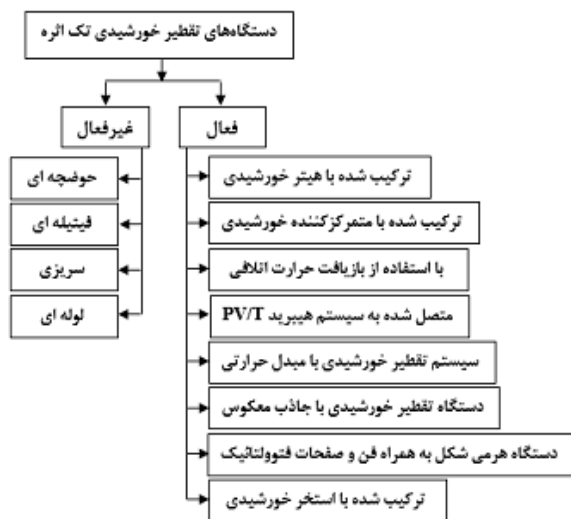
شکل ۴- طراحی‌های متنوع برای سیستم‌های تقطیر خورشیدی فعال و غیرفعال [۳]
