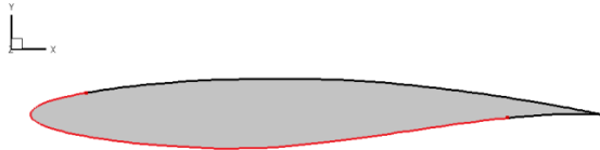
شکل ۱۱: شار حرارتی اعمال شده روی ایرفویل در آزمایش دوم
