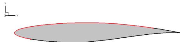
شکل ۹: شار حرارتی اعمال شده روی ایرفویل در آزمایش اول
