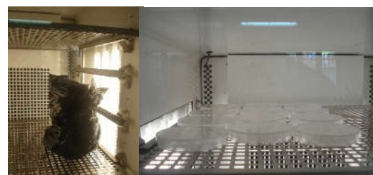
شکل ۶- راست، تشتک‌های کشت شده بذرهای سالیکورنیا پوشیده درون فویل آلومینیومی و کیسه پلاستیکی سیاه برای جلوگیری از نفوذ نور و چپ، پتری‌های در معرض نور (تصاویر تهیه شده به‌وسیله نویسنده مسئول).
