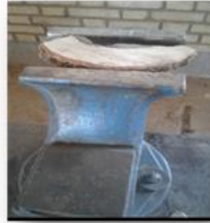
شکل ۲- صاف سازی سطوح دیسک های نمونه جهت مشخص شدن دایر سالیانه
