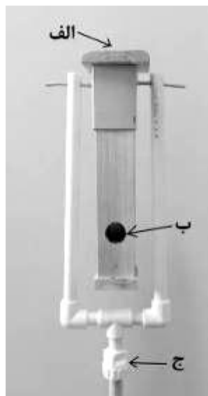
شکل ۱- دستگاه مشابه کاجانوس تیوب ساخته‌شده برای پژوهش الف: پنجره دیدروی عمودی، ب: محل دیدروی با چشم، ج: دستگیره
