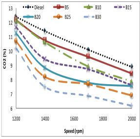
**شکل ۷.** تغییرات دی اکسید کربن بر حسب دور موتور در درصد های مختلف بیودیزل
