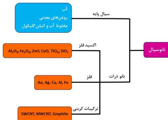
شکل ۷- برخی از سیالات پایه و نانوذرات مختلف به کار برده شده در PTC
