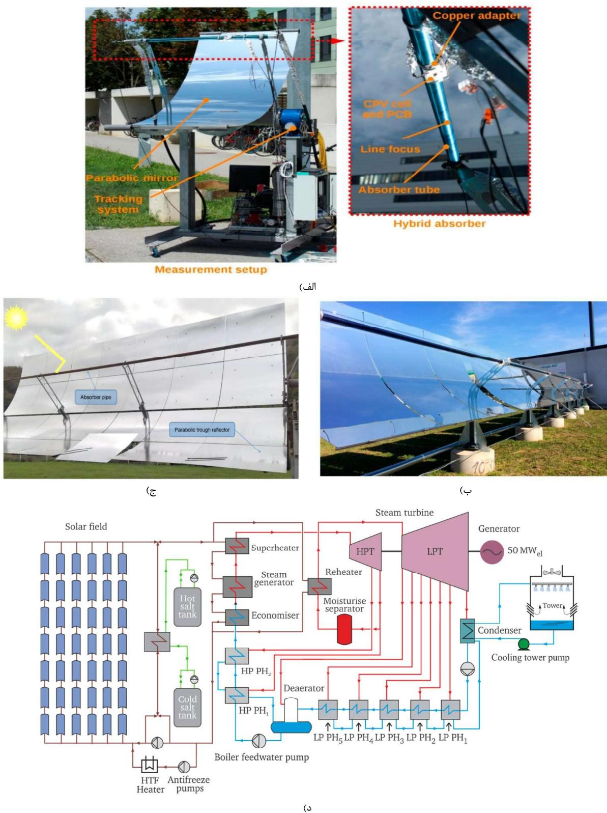
شکل ۲- (الف) نمونه‌ای از سیستم PTC کوچک [۲۲] (ب) واحدهای خورشیدی در اتریش [۲۲] (ج) نمونه‌ای از کلکتور سهموی چندتکه [۲۳] (د) شماتیک نیروگاه خورشیدی شامل مجموعه واحدهای PTC، واحد ذخیره انرژی حرارتی و واحد تولید برق [۲۴].
