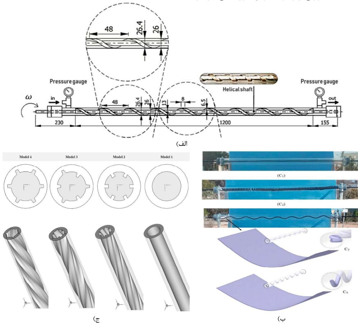
شکل ۸- استفاده از مغشوش‌کننده‌های متنوع در لوله جاذب PTC. (الف) مقطع طولی نمونه آزمایشگاهی شفت مارپیچی داخل لوله گیرنده، ابعاد به میلی‌متر [۶۸] (ب) نمونه آزمایشگاهی مسیر مارپیچی (ج) لوله جاذب با پره‌های محوری مارپیچ داخلی [۷۰].
