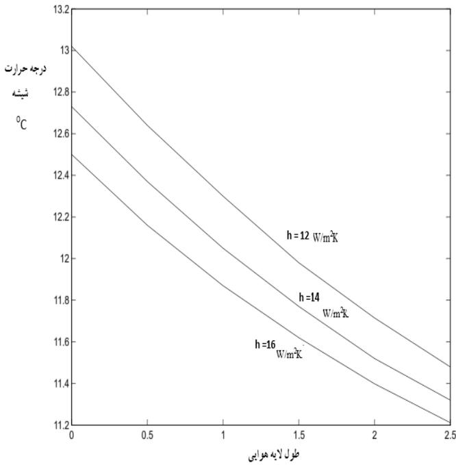
شکل ۳- تغییرات درجه حرارت شیشه با توجه به سه ضریب انتقال حرارت متفاوت برای سطح بیرونی شیشه (شدت تابش مورد مطالعه  $466/81 \text{ W/m}^2$ )
