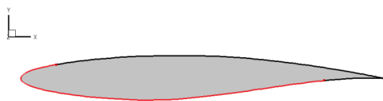
شکل ۱۱: شار حرارتی اعمال شده روی ایرفویل در آزمایش دوم
